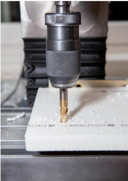
Le matériau possède une excellente ductilité ; cela signifie que les irrégularités du support sont compensées sans dommages. **BT Pro Foam** est insensible à l'humidité et au gel. Il empêche le gonflement et le retrait et il rend le matériel résistant au vieillissement, au pourrissement et imputrescible.
