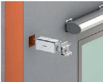
Les façades à niveau d'isolation thermique croissant nécessitent aussi de nouvelles solutions de fixation pour le montage des stores, puisqu'en général, les systèmes de fixation actuels fonctionnent uniquement jusqu'à une épaisseur de 160 mm. Le bloc de montage **CF 200** innovant est un moyen simple et économique pour fixer des stores sans pont thermique dans le système ETICS (isolation thermique par l'extérieur).
